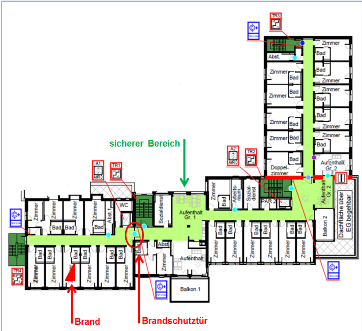
Abb.: Brandbereich und beispielhafter sicherer Bereich
